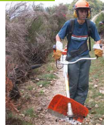
Une débroussailluse thermique montée avec un couteau Duro-broyeur.
