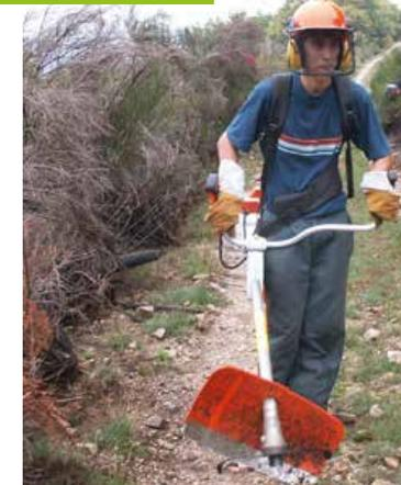
Une débroussailleuse thermique montée avec un couteau Duro-broyeur.
