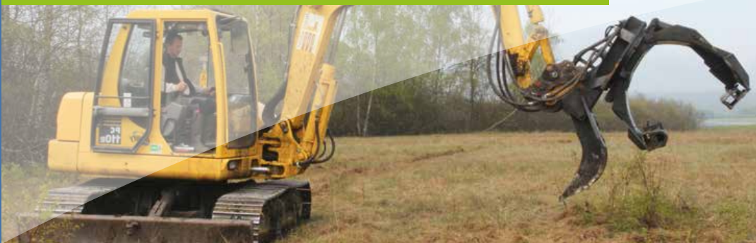
Pince d'arrachage de l'entreprise Mouchet, montée sur pelle mécanique.
